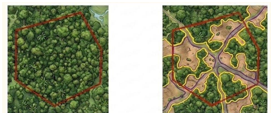
Figura 7 - Áreas florestais elegíveis (limite vermelho, à esquerda) e inelegíveis 26 dentro do limite de um projeto quando há estradas e desmatamento (amarelo, à direita). Para esclarecer: na imagem da direita, se essa fosse a situação no início do projeto, apenas as áreas florestais contornadas em amarelo seriam incluídas na 'área do projeto'. Manchas de não floresta já existentes não seriam 'floresta' e, portanto, por definição, não podem ser incluídas na área do projeto submetida a padrões independentes, como a Verra ou a Cercarbono. Fonte: Space Intelligence.
